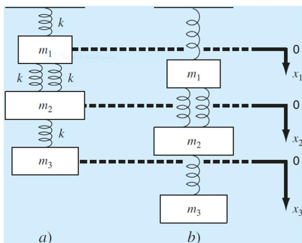
Figura 1: Un sistema compuesto de tres masas suspendidas verticalmente por una serie de resortes. *a)* El sistema antes de ser liberado, es decir, antes de la extensión o compresión de los resortes. *b)* El sistema después de ser liberado. Observe que las posiciones de las masas están en referencia a las coordenadas locales con orígenes en su posición antes de ser liberadas.
